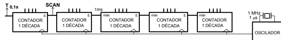
A fin de reducir líneas de conexión (6 cifras BCD requieren 24 líneas, que pasan a ser 42 después de los conversores a 7 segmentos), la representación sobre el visualizador será de tipo dinámico, según el esquema de multiplexado que sigue:
