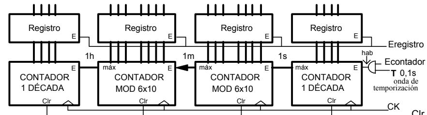
Como reloj se utilizará un oscilador de precisión con cristal de cuarzo de 1 MHz; por división de esa frecuencia (mediante 5 décadas) se obtendrá la onda de temporización de 0,1 segundo (100 Hz) que es la unidad de tiempo para el contador de la figura anterior. Asimismo, se obtendrá la señal de temporización para el barrido de los visualizadores (véase la figura de la página siguiente) que será de 100 Hz.
