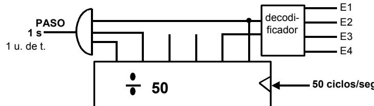
De manera que el circuito integrado completo tendrá los siguientes terminales (se aprovecha como reloj la propia señal de la red eléctrica: 50 Hz, 10 ms):
