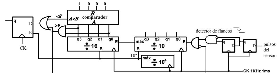
El conteo de pulsos se hace en BCD y se compara con 80 y con 90; cuando llega a 90 se detiene para evitar que el contador «se dé la vuelta». El intervalo de medida (10") se obtiene dividiendo por  $10^4$  la frecuencia de reloj (1 KHz); al final de dicho intervalo se ejecutan las comparaciones (biestable de salida) y se borra el contador para iniciar una nueva medida.
